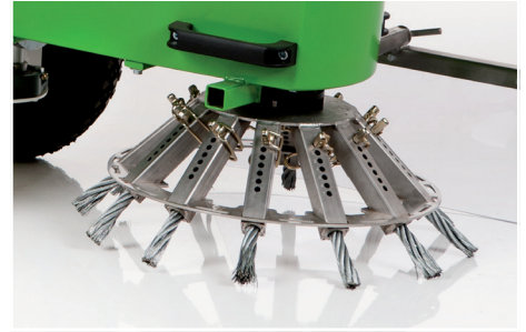
Roestvrij, stalen en roestvrije conische borstelkop waarbij men de borstelplukken aan de hand van de borgpennen geleidelijk uit de borstelgeleider kan laten komen. De motor is direct gemonteerd op de borstel-as met trilling dempers. Men kan hierin zowel getorste, bladstalen(lamellen) of nylon borstels monteren.
